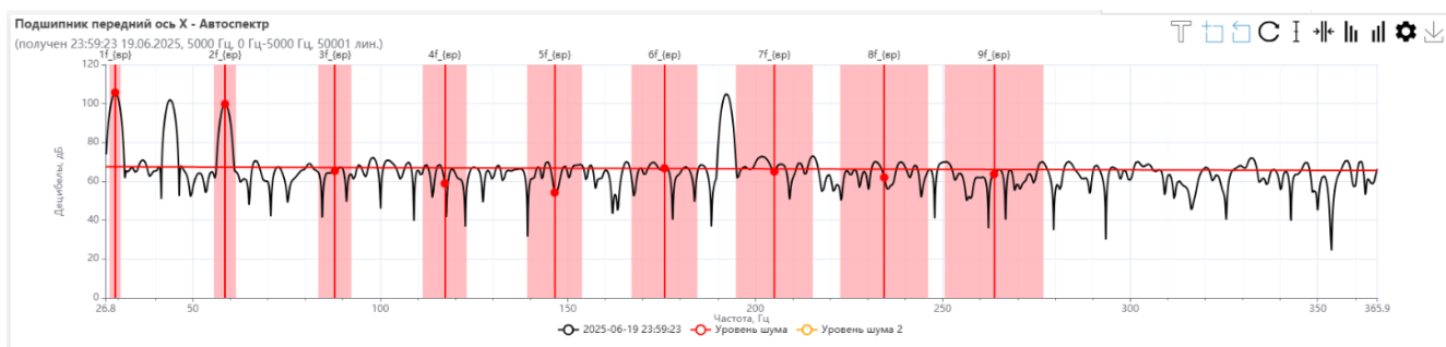
Частоты дефекта: Автоспектр
