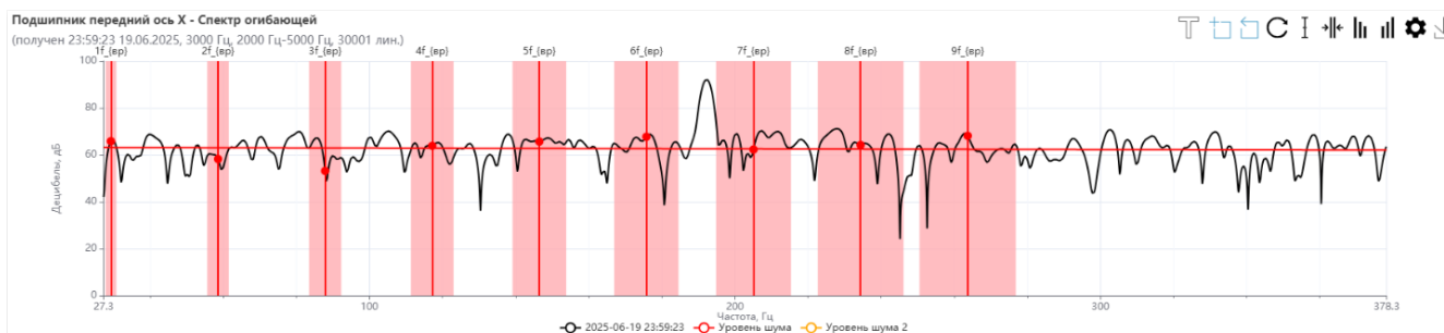
Частоты дефекта: Спектр огибающей
